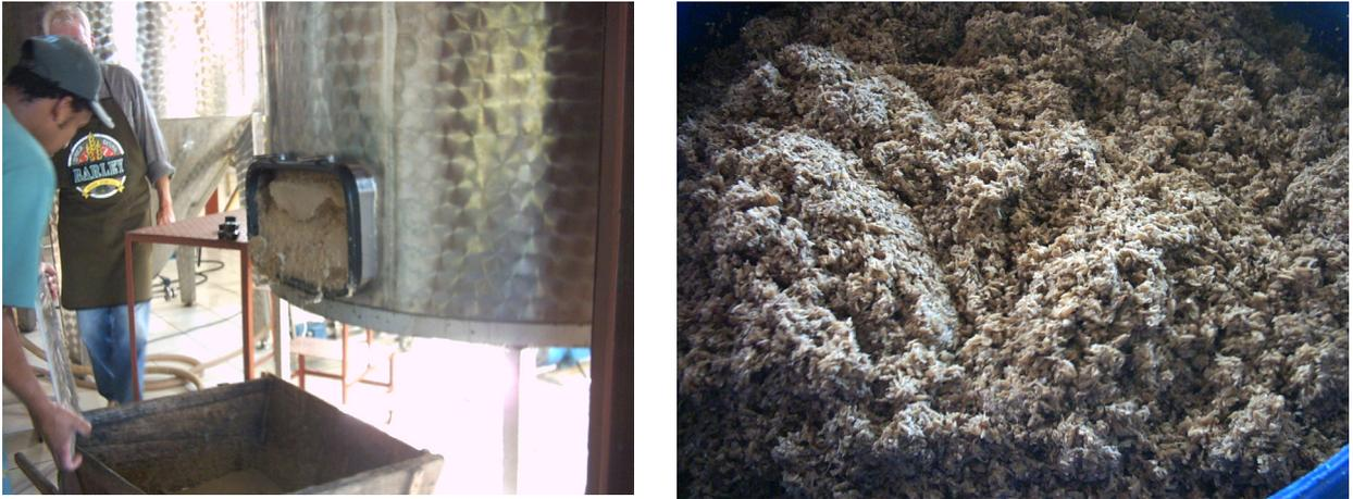
Figura 1 – Remoção do resíduo úmido de cervejaria da tina de mosturação.
